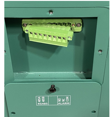
Клеммник RS-485 (485A / 485B) + аварийное реле
